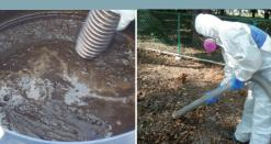
サイクロンとテフロ ンラミネートフィル ターにより、液体また は水分を含んだ物質 を回収できます。
