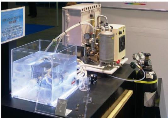
液中の有機物を分解し殺菌・脱臭・脱色ができる強力酸化分解装置です。「殺菌処理に次亜塩素酸などの薬品を使えない」、「水溶液の臭気を除去したい（においを取りたい）」、「色度を基準以下まできれいにしたい（色を取りたい）」などの課題を解決。病院、飲食店、食品加工場、下水処理場など脱色・殺菌・廃棄汚水浄化が必要な施設にメリットがあります。
