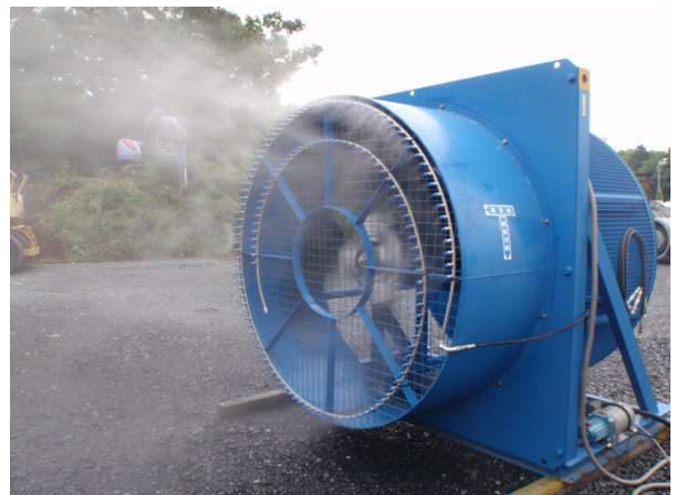
冷却能力 180kW 風量 2100 m 3 /min
